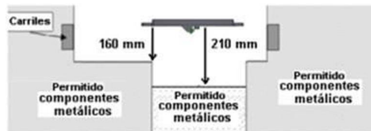
Figura 1. Vista longitudinal de la vía en placa mostrando el cajeado necesario para la instalación de una baliza ASFA Logytel Digital genérica de ancho mixto L1-L9
